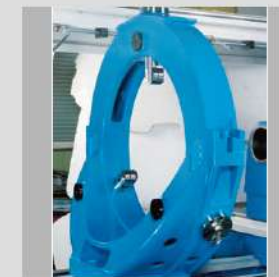
中心架 (CL-78) Steady rest for CL-78
