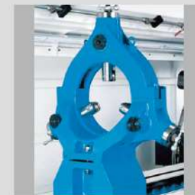
中心架 (CL-68) Steady rest for CL-68
